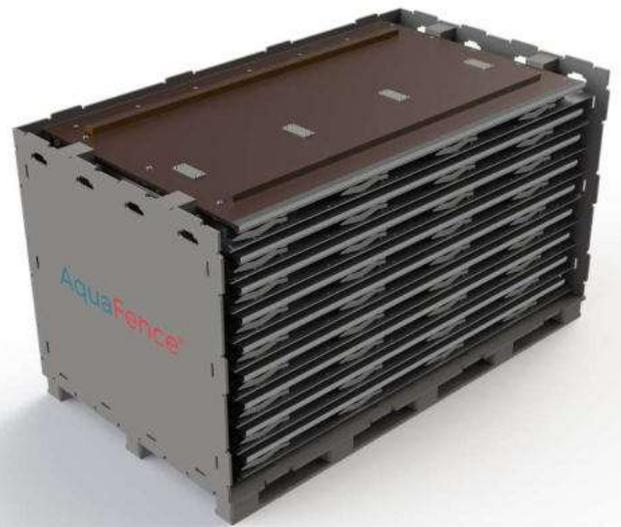
AquaFence Hochwasserschutz Elemente werden in stapelbaren, wiederverwendbaren und wetterbeständigen Kisten geliefert. Je nach Höhe des Lagerraumes können bis zu vier Kisten übereinander gestapelt werden. Generelle Abmessungen sind 1,3 m Breite x 2,25 m Tiefe. Dies erlaubt es 10 Kisten auf einem Standardparkplatz von 2,7 m x 6 m zu lagern, bei 2 übereinandergestapelten Kisten. Eine leere Kiste wiegt 115 kg.
